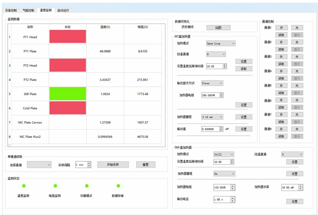
图五 某型号稀释制冷机空载测试 100mK 制冷功率
