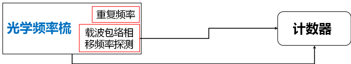
图 5 载波包络相移频率稳定性测试框图
